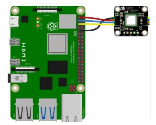
Pi 3V to sensor VIN (red wire)
