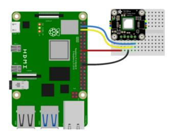
Pi 3V to sensor VIN (red wire)
